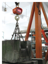
5000kgの精度チェックです。液晶に5000kgと出ており、検査は合格です。
