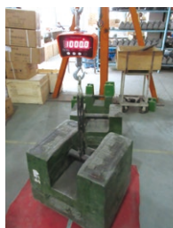
OCS-1-Mの精度チェックです。1000kgの分銅で、1000kgの表示がされています。
