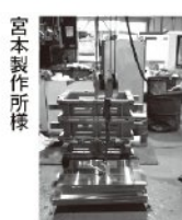
宮本製作所様 (100kgのリフティング マグネットを用いています)
